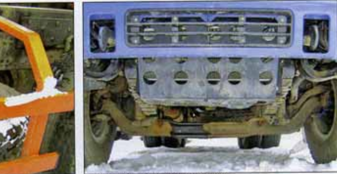
СПЕЦИАЛЬНО ДЛЯ РОССИЙСКОГО РЫНКА ГРУЗОВИКИ ОСНАЩАЮТ ЗАЩИТОЙ РАДИАТОРА И КАРТЕРА ДВИГАТЕЛЯ
