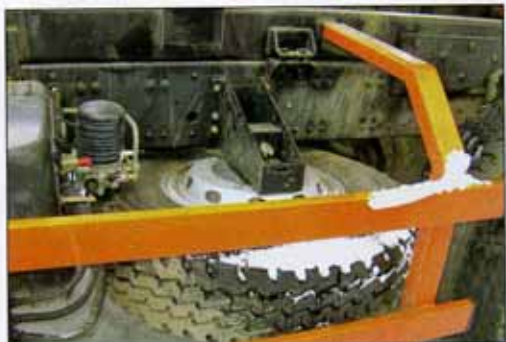
«ЗАПАСКА» РАСПОЛОЖЕНА В БАЗЕ. ПРИ ЕЕ ОТСОЕДИНЕНИИ РАБОТАТЬ СЪЕМНОЙ РУКОЯТКОЙ МЕШАЮТ БРУСЬЯ БОКОВОЙ ПРОТИВОПОДКАТНОЙ ЗАЩИТЫ
