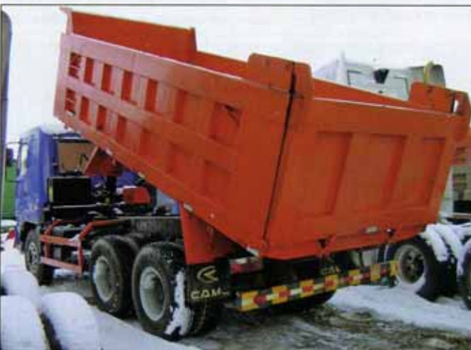
САМОСВАЛ ОБОРУДОВАН КОРОБЧАТЫМ 15-КУБОВЫМ КУЗОВОМ, НА ЗАДНЕМ БОРТУ КОТОРОГО УСТАНОВЛЕНА АВТОМАТИЧЕСКИЕ ЗАПОРЫ
