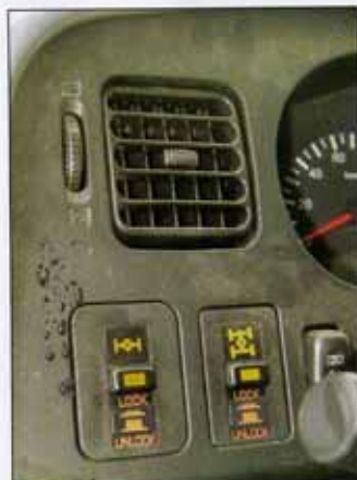
КНОПКИ ВКЛЮЧЕНИЯ МЕЖКОЛЕСНЫХ И МЕЖСЕКОВОГО ДИФФЕРЕНЦИАЛОВ
