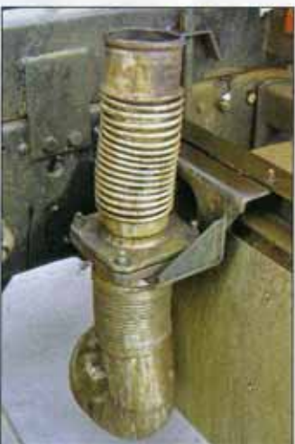
ПОДГРЕВ САМОСВАЛЬНОЙ ПЛАТФОРМЫ ОТ ВЫХЛОПНОЙ СИСТЕМЫ
