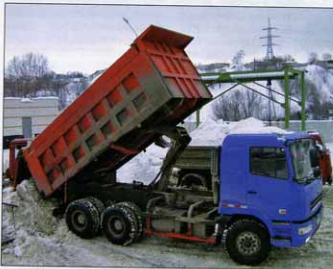
ЭТОТ САМС — ИЗ ПЕРВЫХ ИМПОРТИРОВАННЫХ В РОССИЮ ПАРТИЙ ГРУЗОВИКОВ. ОН ОБОРУДОВАН ГИДРОЦИЛИНДРОМ, РАСПОЛОЖЕННЫМ ПОД КУЗОВОМ. НА ПЛАТФОРМЕ ВИДНЫ САМОСТОЯТЕЛЬНО УСТАНОВЛЕННЫЕ НАДСТАВНЫЕ БОРТА
