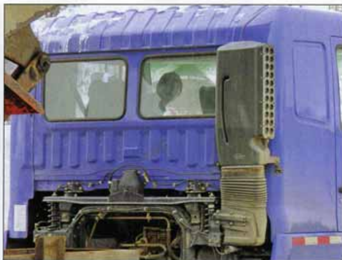
МЕХАНИЧЕСКАЯ ПОДВЕСКА КАБИНЫ И ВОЗДУХОЗАБОРНИК
