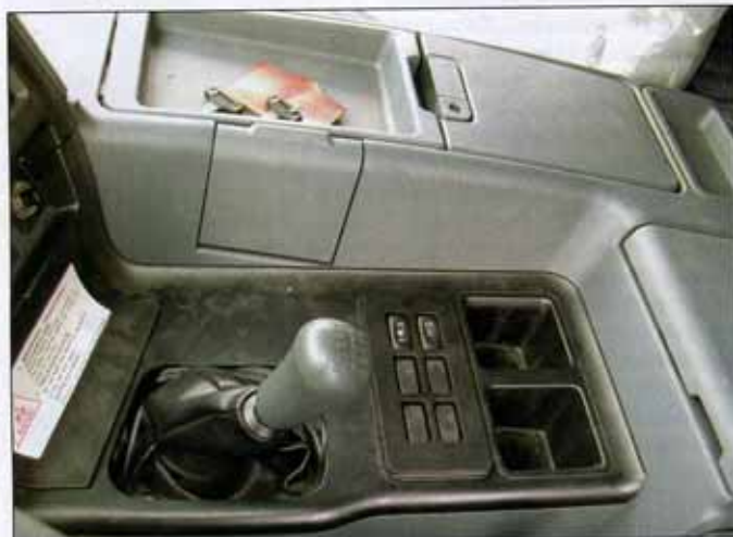
В ЦЕНТРАЛЬНОЙ ЧАСТИ КАБИНЫ СКОМПОНОВАНЫ УДОБНЫЙ КОРОТКОХОДНЫЙ РЫЧАГ МЕХАНИЧЕСКОЙ КП И МНОЖЕСТВО ВСЕВОЗМОЖНЫХ ВЕЩЕВЫХ ОТДЕЛЕНИЙ
