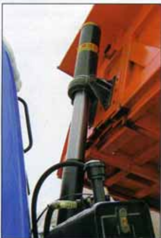
НА РОССИЙСКОЙ ВЕРСИИ САМОСВАЛА ГИДРОЦИЛИНДР ТЕПЕРЬ УСТАНАВЛИВАЮТ НЕ ПОД КУЗОВОМ, А ПЕРЕД ЕГО ПЕРЕДНИМ БОРТОМ
