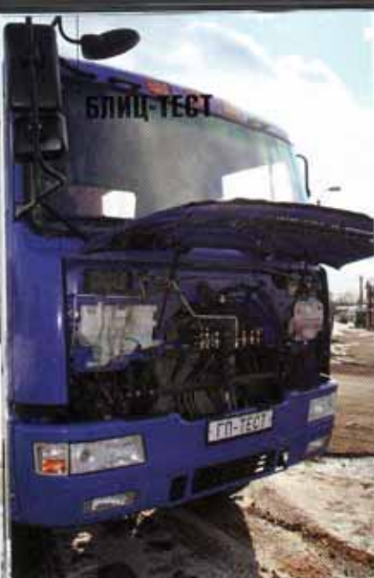
Под капотом только заправочные горловины
