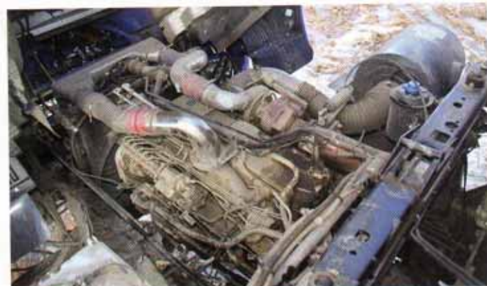
В качестве силового агрегата используется лицензионный двигатель Cummins, изготовленный в Китае компанией DongFeng
