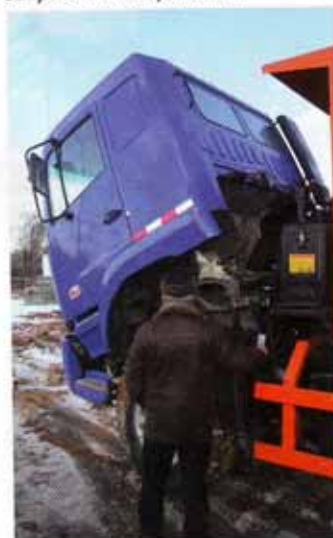
В дополнение к ручному гидронаосу кабина оборудована еще и электрическим подъемником
