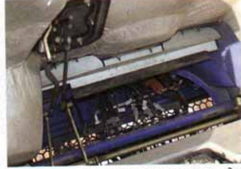
Механизм переключения передач многорычажный
