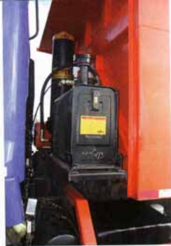
Вся гидросистема самосвала изготовлена в Китае по лицензии фирмы Нува
