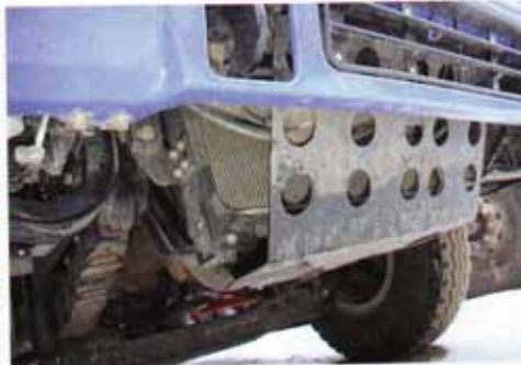
Заводская защита радиатора снизу устанавливается на все автомобили
