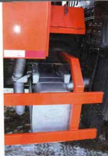
Самосвальный кузов с подогревом от выхлопных газов
