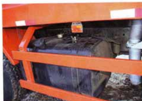
На машине штатно установлен топливный бак на 400 л
