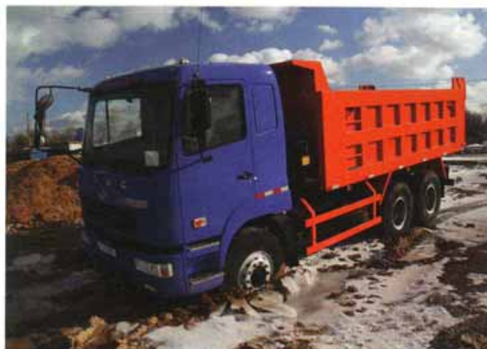
Казалось бы, безобидная ситуация, но мы застряли, несмотря на наличие блокировок. Причина – дорожная резина с неподходящим рисунком протектора
