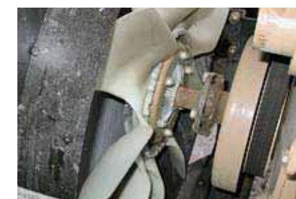
Вентилятор с вязкостной муфтой установлен на переднем носке коленвала
