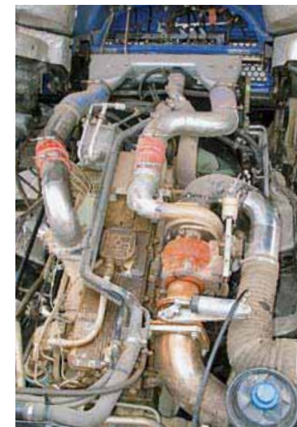
Cummins серии «L» – компактный, мощный и легкий, его масса 650 кг
