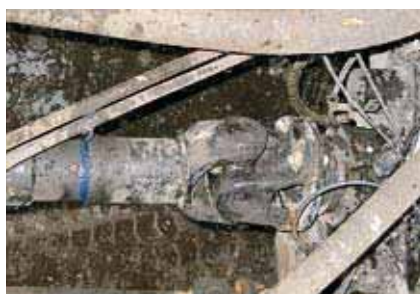
Кардан крепится по-европейски, на торцевых шлицах и четырех болтах
