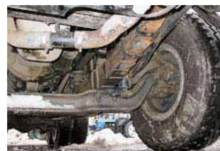
Просвет под передней балкой 300мм, к стартеру подбираются только снизу
