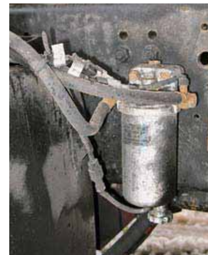
Топливный фильтр-отстойник с датчиком воды, но без электроподогрева
