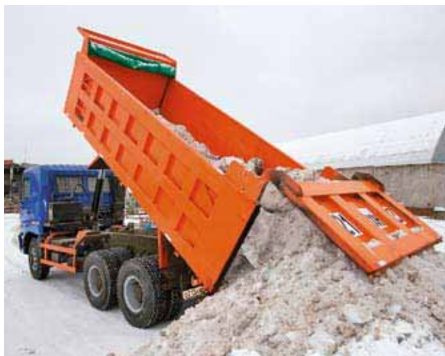
У ведущих мостов отличный клиренс 330 мм и очень удачно, в лонжеронах рамы спрятаны тормозные камеры
