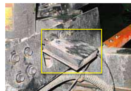
Под крышкой спрятан электро-пневматический клапан подъема кузова
