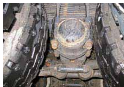
К гайкам стремянок нужно подбирать с низу. Штанги на сайлент-блоках
