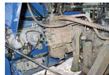
Гидроусилитель руля мощный, и самое главное – сухой, без подтеков масла
