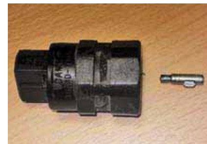
На датчике электрического спидометра свернуло приводной валик
