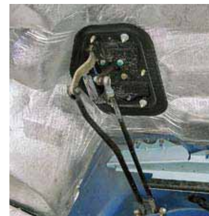
Подобная кулиса привода коробки передач была на «Москвич-412»
