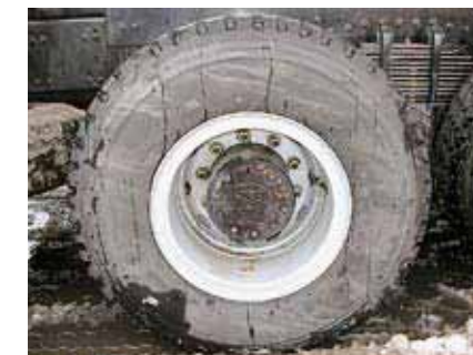
У САМС свои мосты, с европейским креплением колес на ступицах
