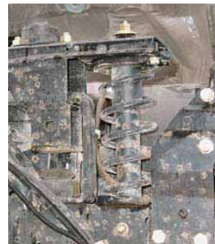
Подвеска кабины без регулировки жесткости пружин. Дешево и сердито!
