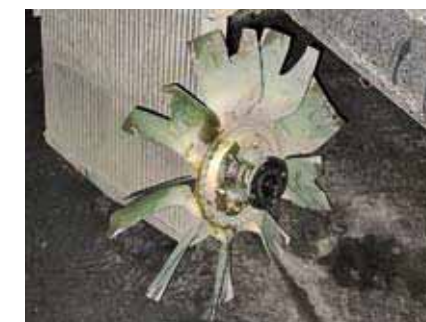
Хорошо, если кусок пластмассового пропеллера не протаранит радиатор
