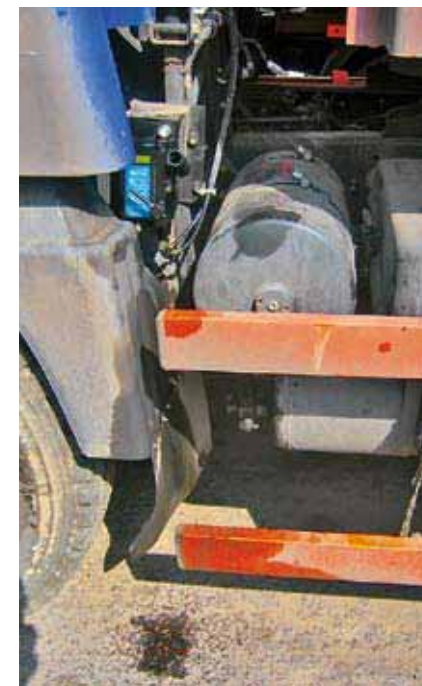
Масло подтекает с трубок насоса подъема кабины
