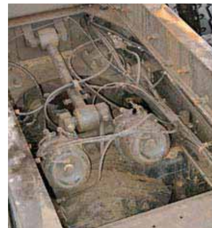
К тормозным камерам проще добраться при поднятом кузове
