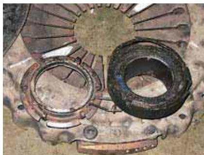
Оборвалась муфта выжимного подшипника и диск сцепления сгорел
