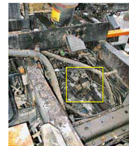
Привод насоса гидроподъемника установки от коробки передач
