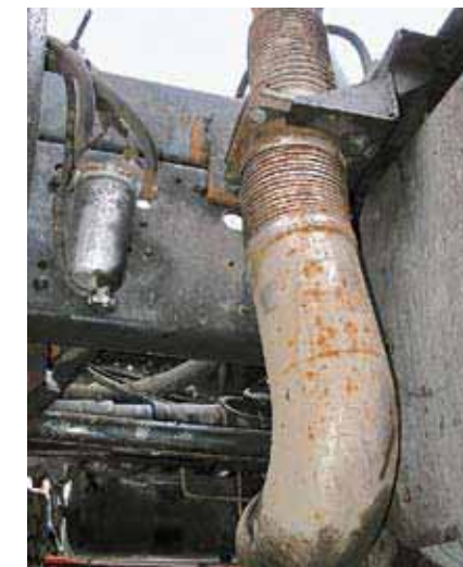
Удивительно, насколько быстро покрываются коррозией выхлопные трубы
