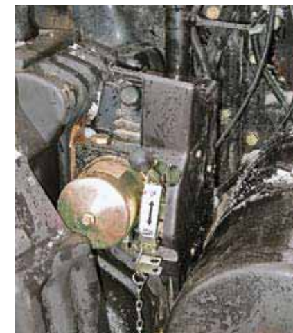
На САМС последних партий механизм подъема кабины с электронасосом
