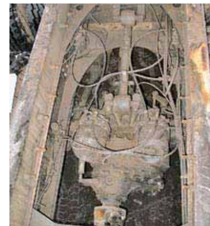
Редуктор среднего моста сделан проходным, карданов всего два
