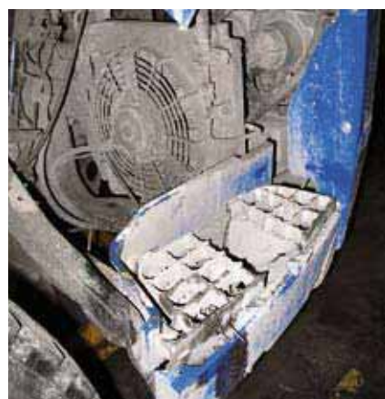
Справа под кабиной нашлось место испарителю кондиционера. Очень грязно!
